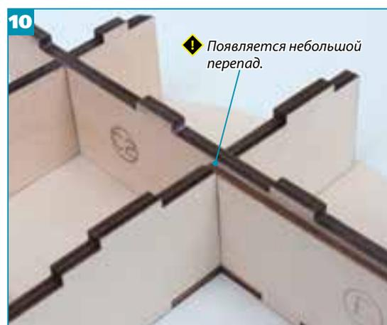
**10** При установке перегородки D также должен появиться небольшой перепад, который будет нужен для устройства погреба.
